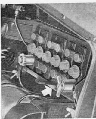
Door de vleugelmoer, welke zich bevindt op de negatieve pool van de accu, twee slagen los te draaien, schakelt men de gehele elektrische installatie uit.
